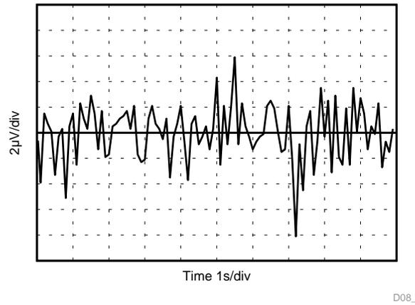
**Figure 27. 0.1-Hz to 10-Hz Noise ( $V_{REF}$ )**
