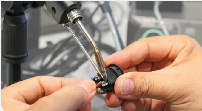
El diseño del soporte fijo permite la manipulación del producto con las dos manos, de esta manera la eficiencia del trabajo mejora considerablemente.
