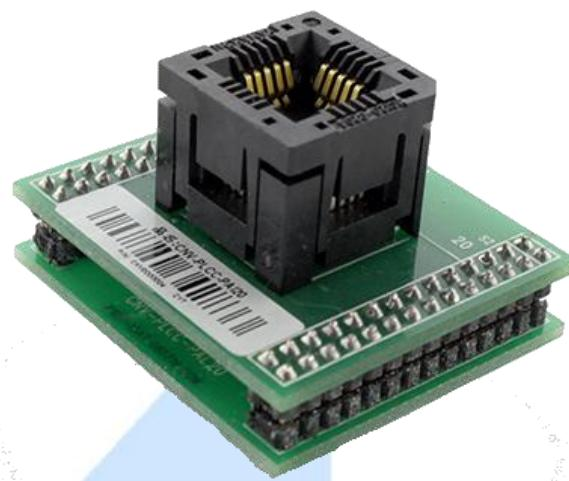
**Descripción:** Es un adaptador de 20 PLCC para el DIP20. Simplemente presione hacia abajo en la parte superior, coloque el chip con cuidado y luego sueltelo para enganchar el chip. El chip se mantiene firmemente contra el oro 'dedos' en el zócalo.
