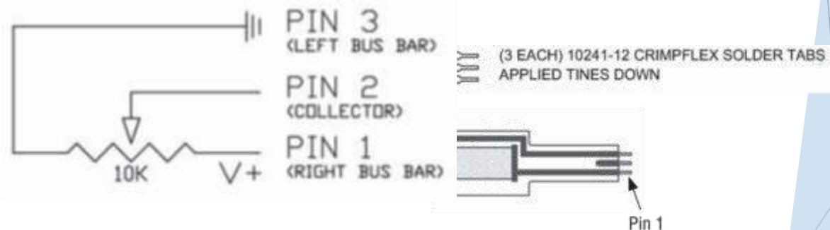
Los sensores del Sensores Flex cambian su resistencia dependiendo de donde se toquen.
