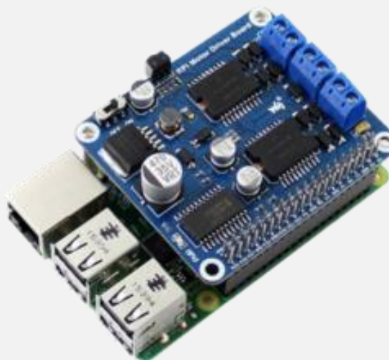
HAT controlador de motor RPi conectado a Raspberry Pi
