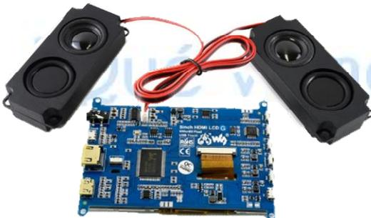
Ejemplo de visualización: Altavoz de 5W con LCD HDMI de 5 pulgadas (G)
