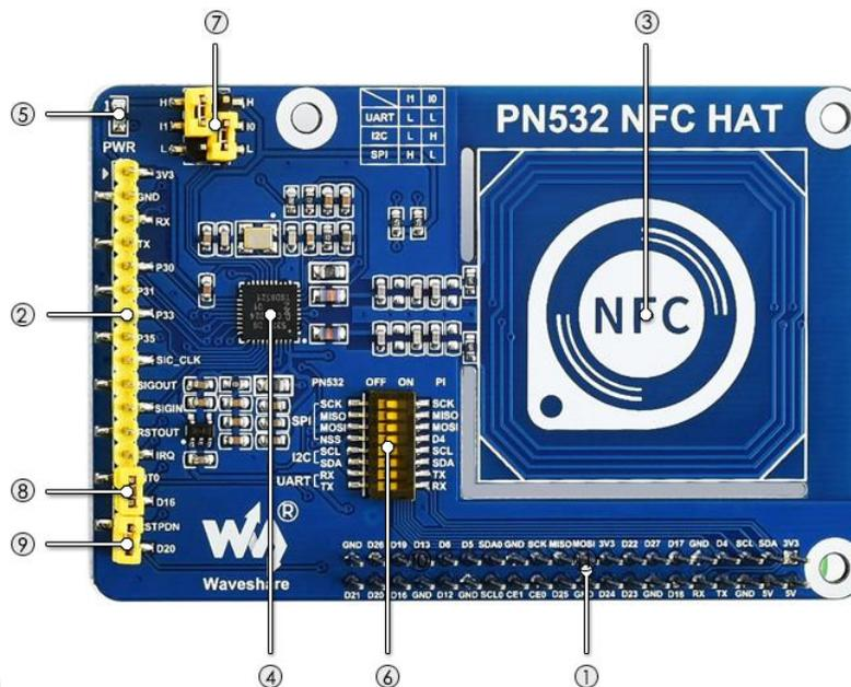
1. Conector GPIO de Raspberry Pi: Para conectar con contactos de control de Raspberry Pi
