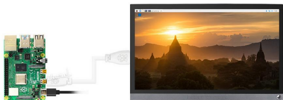
Ejemplo de conexión Raspberry Pi 4 a la pantalla
