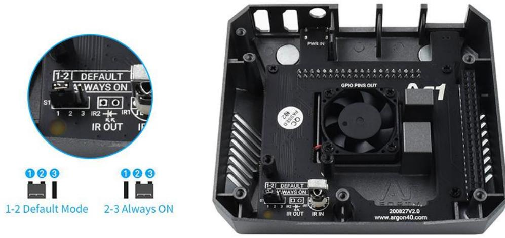
Los pilares de extensión hacen que la caja de aluminio se convierta en un gran disipador térmico para transferir el calor de la placa, combinado con el ventilador de refrigeración y múltiples respiraderos de flujo de aire, el efecto de enfriamiento no puede ser mejor
