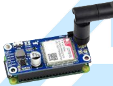
Conexión con Raspberry Zero WH
