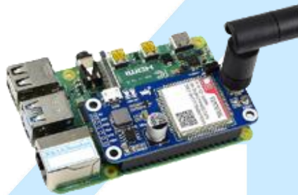
Conexión con Raspberry Pi 4
