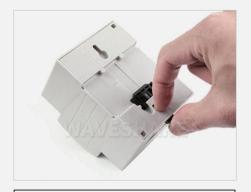
1. Presione el bloqueo del riel con el dedo índice, luego empújelo hacia afuera como se muestra en la imagen.
