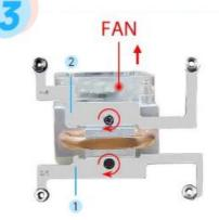
3. En los puntos 1 y 2 se conecta la parte inferior del ventilador de refrigeración con tornillos.
