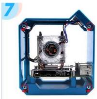
7. Fije el deflector de acrílico transparente a ambos lados de la caja con tornillos
