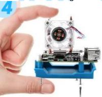
4. Mantenga presionado ligeramente el extremo superior del tubo de cobre e instale los tornillos desde la parte inferior para fijar el Pi4 y esta placa base azul.
