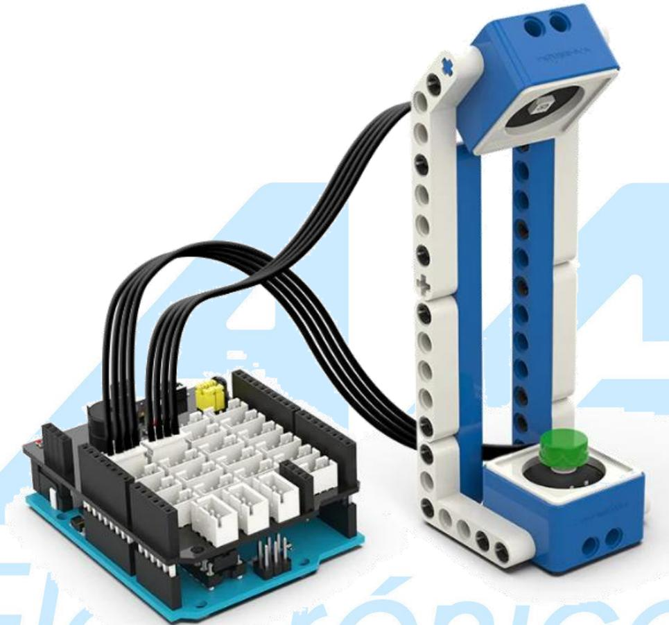
No solo es compatible con la serie de módulos de sensores, sino que también es compatible con los módulos de sensores generales de Yahboom. También puede admitir módulos de sensor con interfaz PH2.0 común en el mercado.
