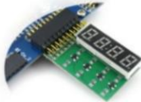
Conexión a la placa LED 8 SEG
