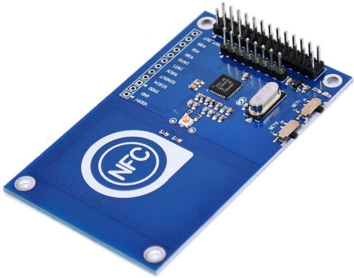
**Descripción:** este lector de tarjetas esta basado en el chip PN532 y trabaja con dispositivos a 13.56MHz. El modulo viene equipado con una antena en el PCB, por lo tanto no se necesita ninguna antena externa.
