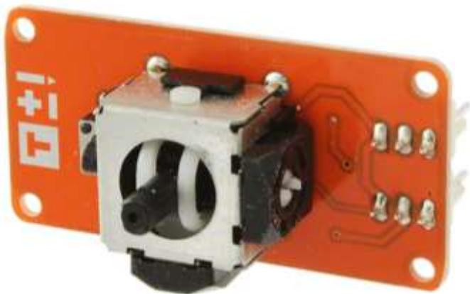
**Descripción:** El módulo Joystick cuenta de dos potenciómetros lineales, dos amplificadores de señal, un indicador LED verde de estado y un indicador LED amarillo que varía de brillo según los valores de salida.
