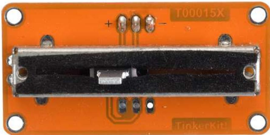
**Descripción:** Este módulo puede encontrarse como un controlador de volumen en radios y televisores. Al mover el control deslizante puede variar la tensión de salida entre 0 y 5V. El valor se envía a través del pin central.
