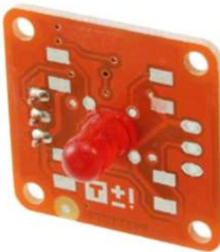
**Descripción:** Es una fuente de luz de baja potencia disponible en muchos colores. Se ilumina cuando se alimenta con un pin Arduino.
