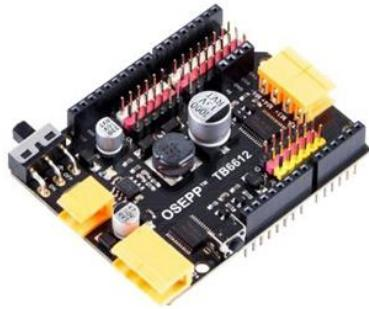
**Descripción:** Cuenta con el chip IC TB6612 para controlar motores de DC. Puede accionar hasta 4 motores de DC con una capacidad máxima de 12Volts a 5Amp.
