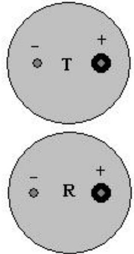
El Transmisor se identifica por una T grabada en el cuerpo del componente y el Receptor con una R; en ambos casos la Terminal positiva esta aislada de la cubierta metálica con una capa plástica.
