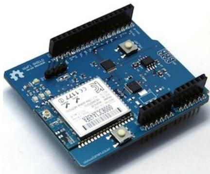
**Descripción:** utilizando el modulo certificado WizFi21, este escudo permite conectar el Arduino a internet de forma inalámbrica. A través de una interfaz SPI, permite una velocidad de trasmisión más rápida.
